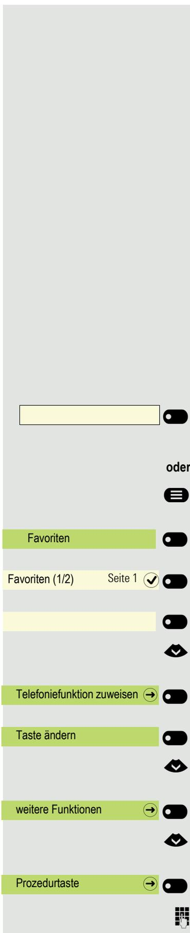
Funktionstaste des OpenScape Key Module 600, die mit einer Funktion belegt werden soll, lange drücken, bis das Menü Tastenprogrammierung angezeigt wird.
